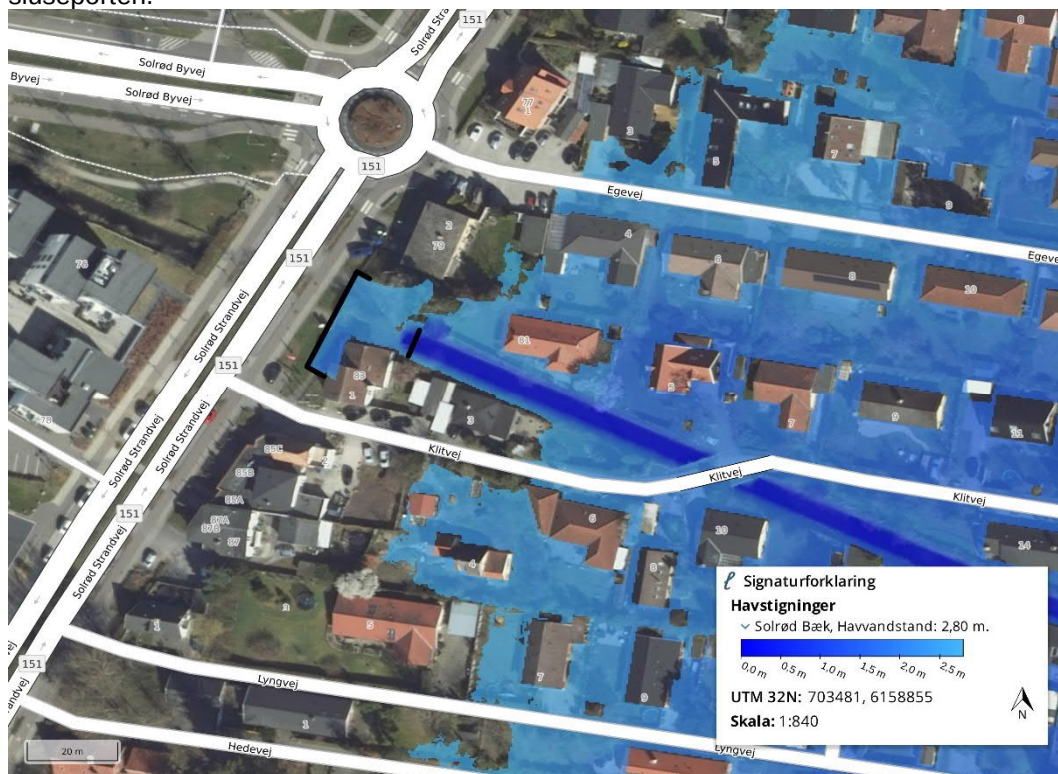
Figur 5-16 Simulering af havvandstand +2,8 ved Solrød Bæk i Scalgo Live
